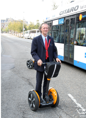
Figura 1: Veículo Segway modelado como um pêndulo invertido.
